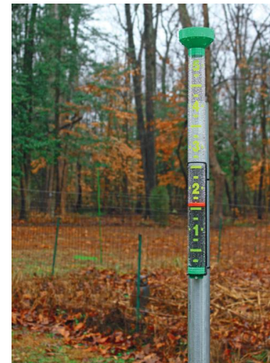
Figura 5.5. El pluviómetro permite conocer con precisión el volumen de lluvia.
