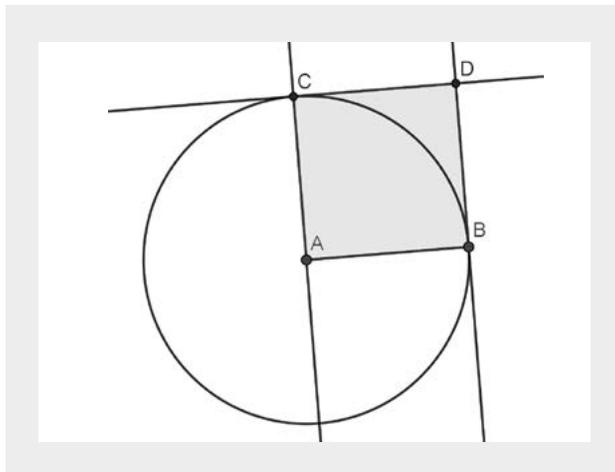
**Figura 12.** Trazado de cuadrado usando “Perpendicular” y “Compás”.
