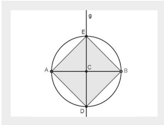
**Figura 14.** A diferencia del dibujo anterior, la recta  $g$  se trazó ahora perpendicular al segmento  $AB$ . Luego se dibujó la circunferencia con centro en  $C$ , pasando por  $A$  (o  $B$ ), y se marcó su intersección con la recta. Posteriormente, usando esos cuatro puntos, se dibujó el polígono  $ADBE$ .
